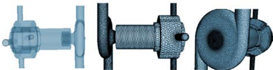
Рис. 2. Расчетная геометрия и сетка, 1 млн ячеек
