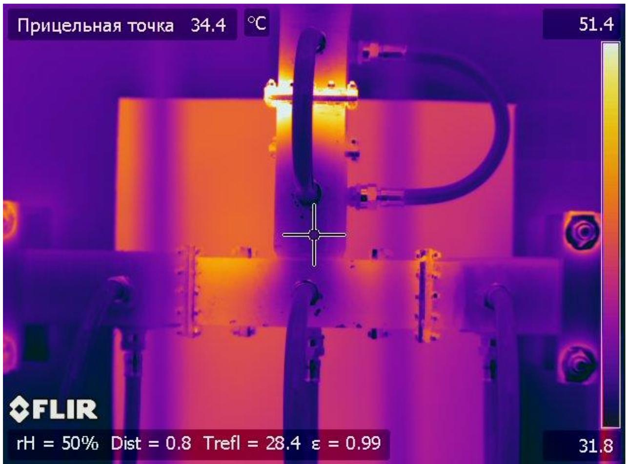
Рисунок 9.7- Нулевые выводы
