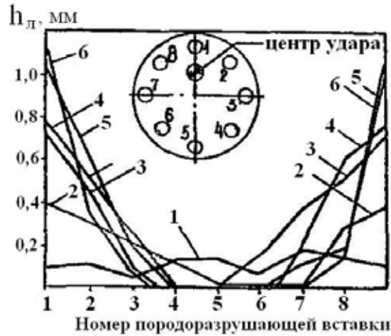
Рис. 4. Глубины лунок разрушения в мраморе, полученные при различной величине эксцентриситета приложения удара e : кривая 1 – e=0 ; 2 – e=1,3 см; 3 – e=2,0 см; 4 – e=2,7 см; 5 – e=3,4 см; 6 – e=4,2 см
