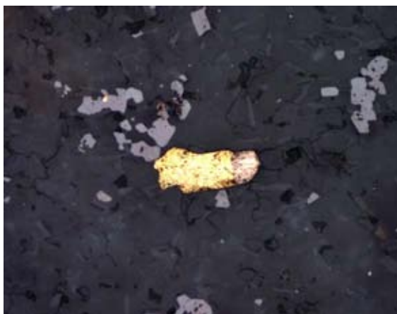
Рис. 10. Золото (желтое) в сростании с пирротинном (серовато-белое). Серое – рутил, черное – метасоматит. Месторождение Герфед. Полированный шлиф. Ник.П. Ув. 200 x
