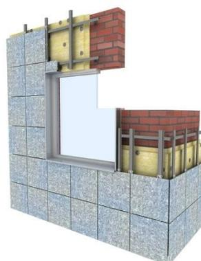
Рисунок 8.9 – Навесной вентилируемый фасад
