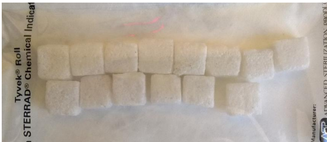
Рисунок 1. Внешний вид макропористых 3D-матриц, полученных методом выщелачивания сахарозы.
