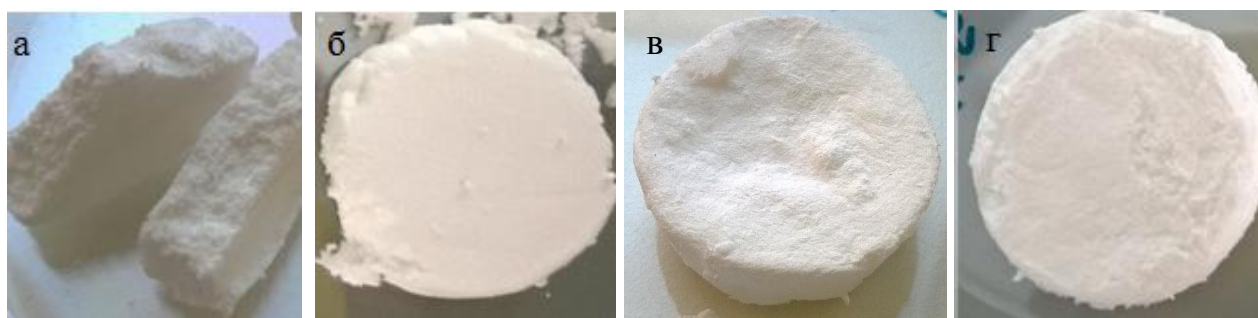
Рисунок 3. Микропористые матриксы, полученные методом лиофилизации
