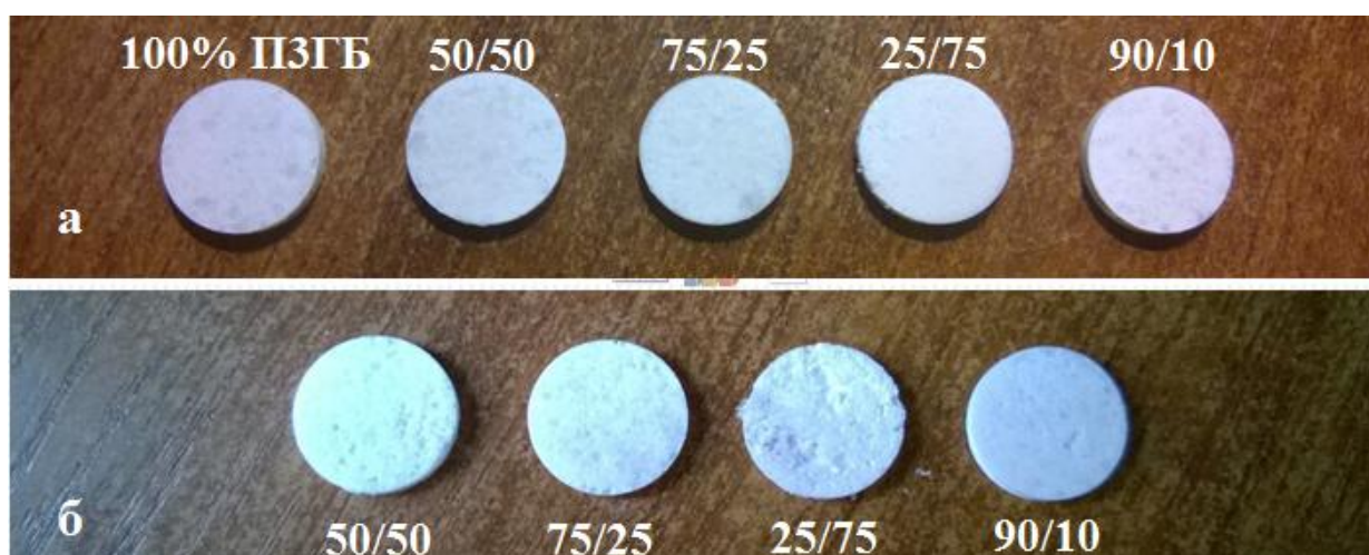
Рисунок 4. 3D-матриксы, полученные методом холодного прямого прессования, соотношение полимер/сахароза; а) до вымывания сахарозы; б) после вымывания сахарозы.
