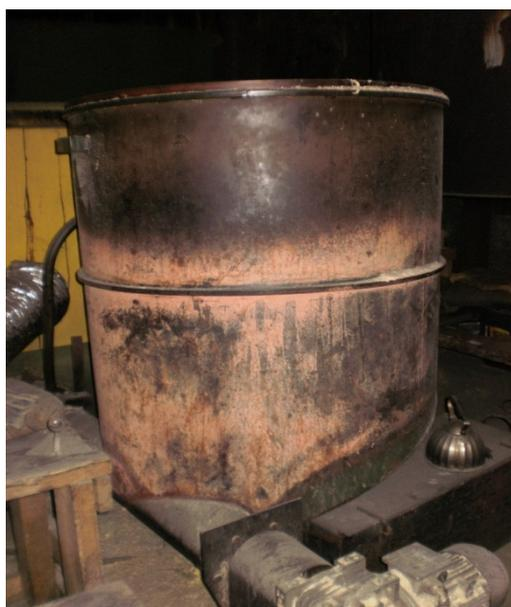
Рисунок 3.5 - Бункер для сыпучего топлива
