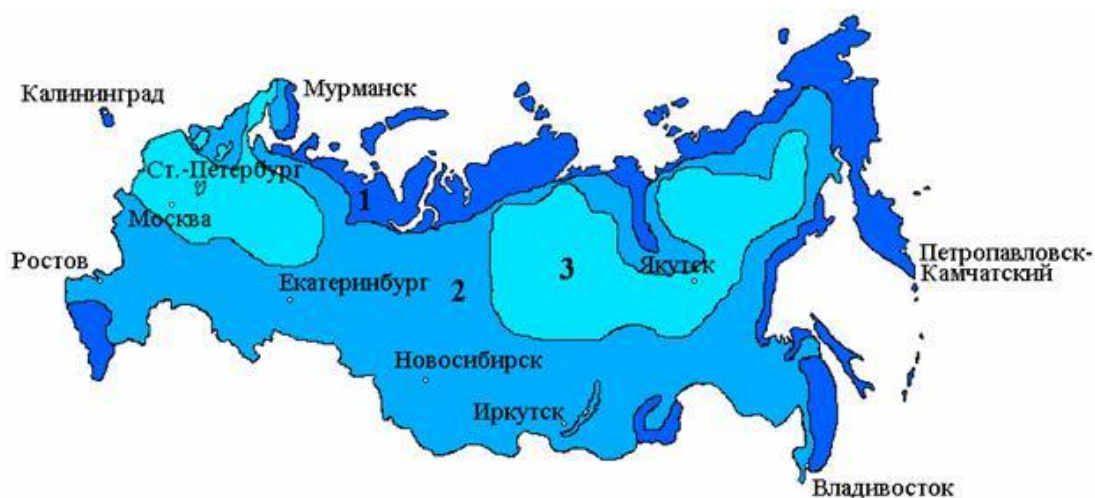
Рисунок 7- Карта ветроэнергетических ресурсов России. Цифрами обозначены зоны со среднегодовыми скоростями ветра: 1- выше 6 м/сек; 2 - от 3,5 до 6 м/сек; 3 - до 3,5 м/сек.
