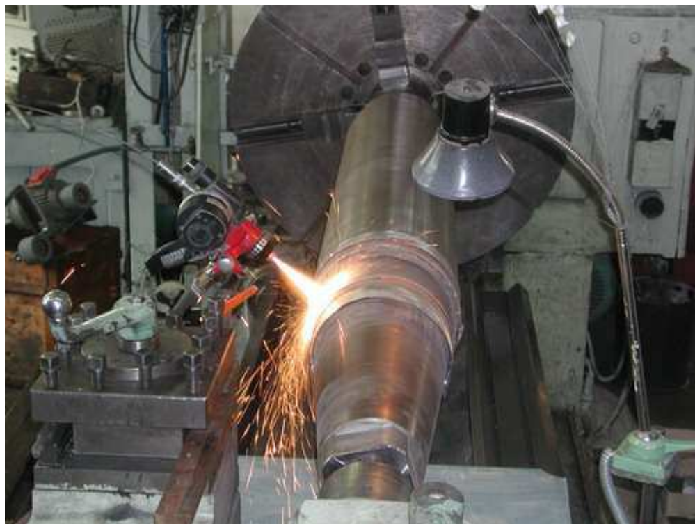
Рисунок 1.6 – Один из вариантов установки для напыления.[8]
