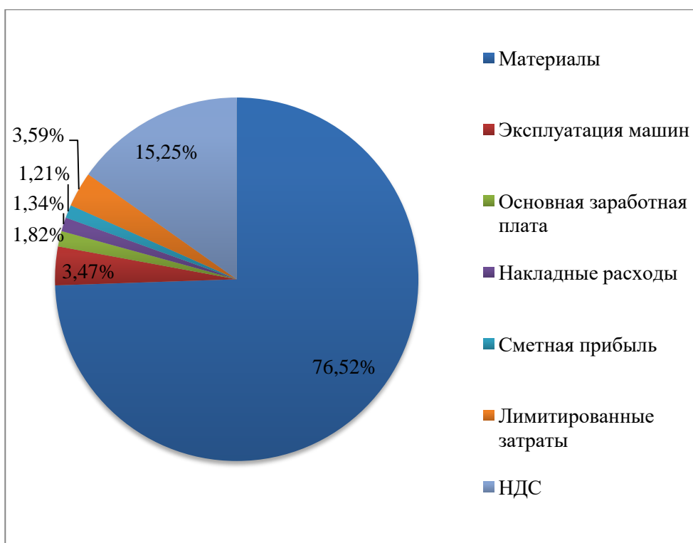
Рисунок 5.4 – Структура локального сметного расчета на устройство свайного поля под холодный склад глинохранилища по составным элементам, %
