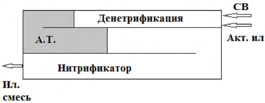
Рис.2. Распределение объемов сооружения между денитрификатором, аэротенком и нитрификатором.
