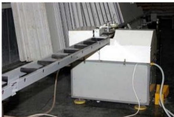
Рисунок 1.10 – Пила для нарезки штапиков ПШ-2
