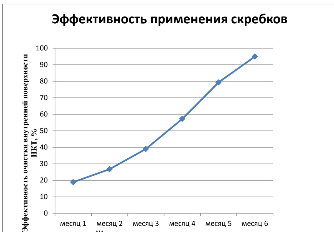
Рис. 3.5 – Эффективность применения скребков для удаления АСПО
