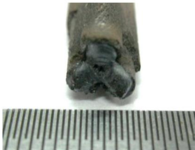
Рисунок 3.21 – Короткое замыкание при включении трехфазной дуги.
