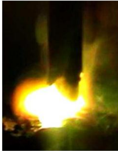
Рисунок 3.14 – Образование общей капли на торцах электродов.
