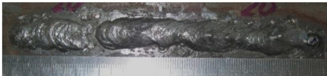
Рисунок 3.16 – Внешний вид валика, выполненного на режимах: I_d= 100 \text{ А.}; U_d=25-28 \text{ В.}
