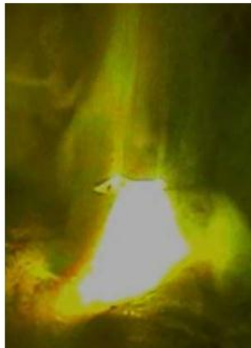
Рисунок 3.15 – Горение расщепленной дуги на режимах: I_d = 110 А.; U_d=25-30 В.
