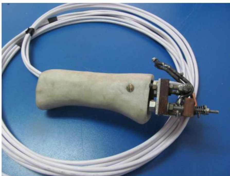
Рисунок 2.4 - Опытный образец трехфазного электрододержателя.
