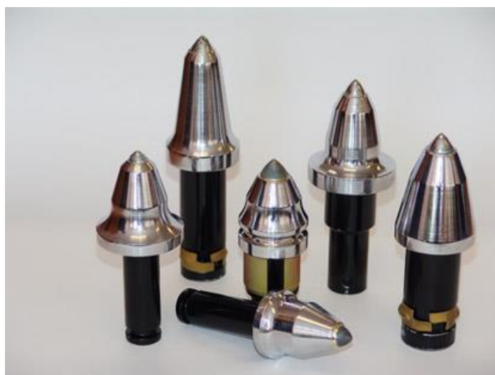
Рисунок 3 – Конструкции поворотных (вращающихся) резцов
