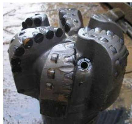
Рисунок 13- Долото PDC Tornado после проходки 1150 м
