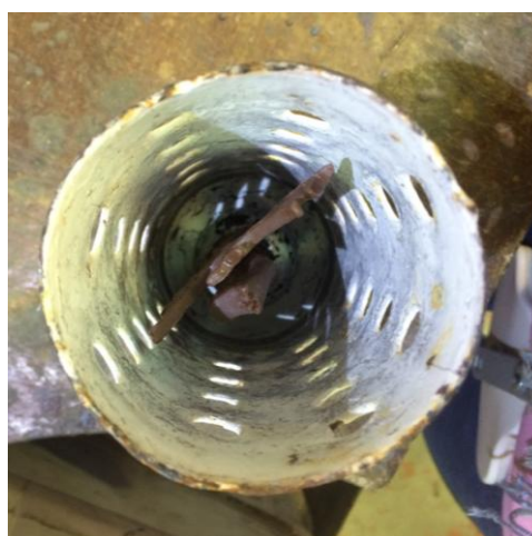
Рисунок 41 – Опока с восковыми моделями
