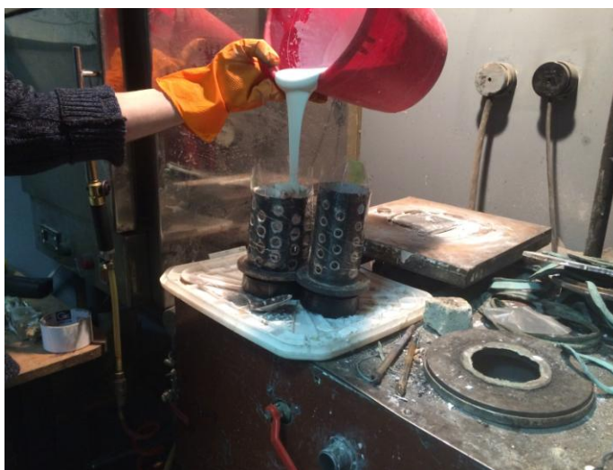
Рисунок 42 – Заливка формовочной смеси в опоки
