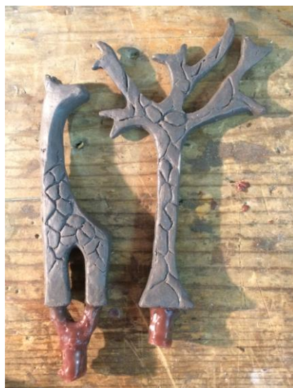
Рисунок 35 – Пластилиновые модели с литниками
