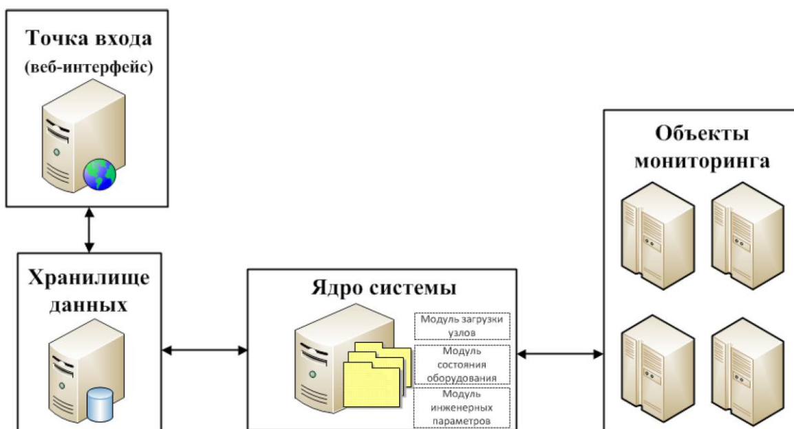
Рисунок 6 – Архитектура разработанной системы мониторинга
