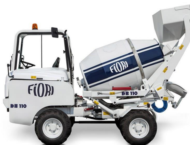
Рисунок 4- Самопогрузчик с перемешивающим устройством
