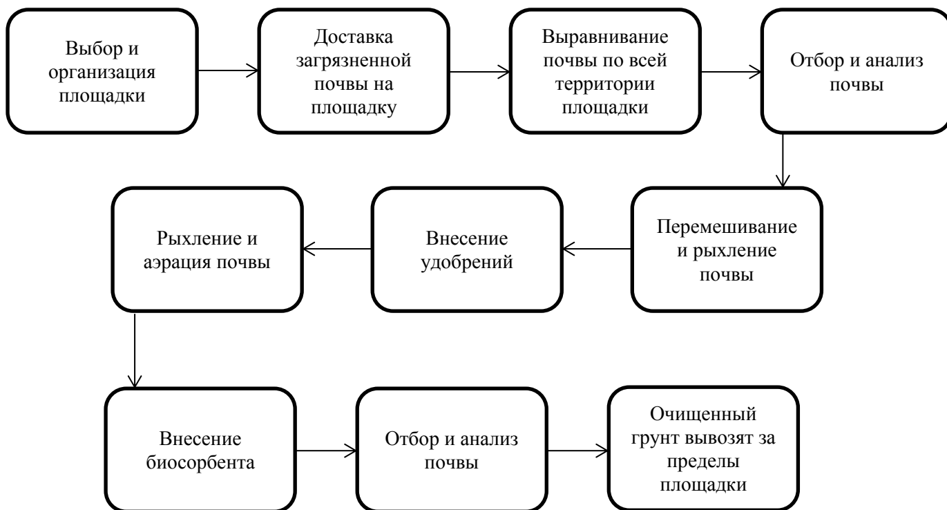
Рисунок 2 - Технологическая схема процесса биоремедиации ex situ
