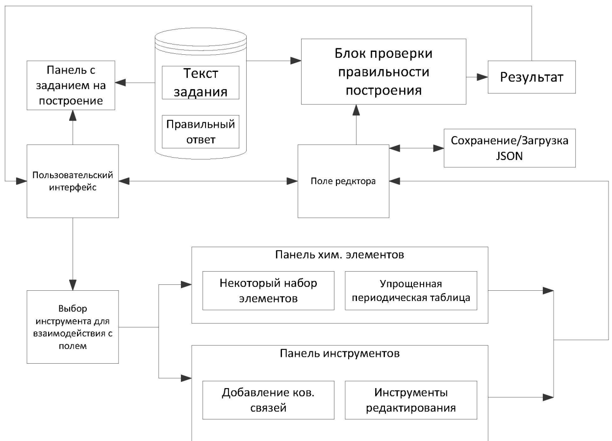
Рисунок В.3 – Функциональная схема редактора
