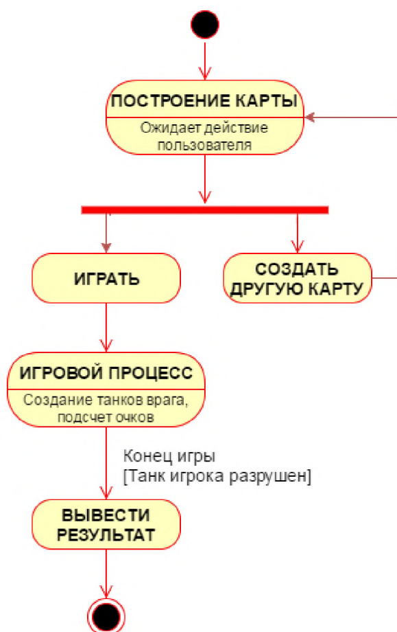
Рисунок 4 – UML диаграмма последовательностей, описывающая общую схему работы приложения
