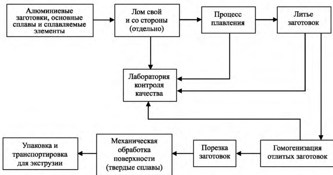
Рисунок 6 - Схема осуществления контроля качества при производстве заготовок
