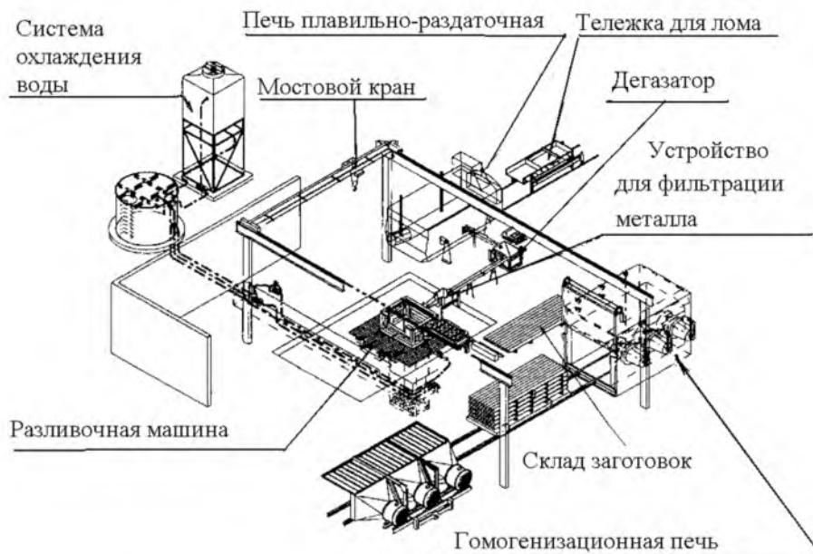
Рисунок 8 - Типичный литейный цех производства заготовок для прессования
