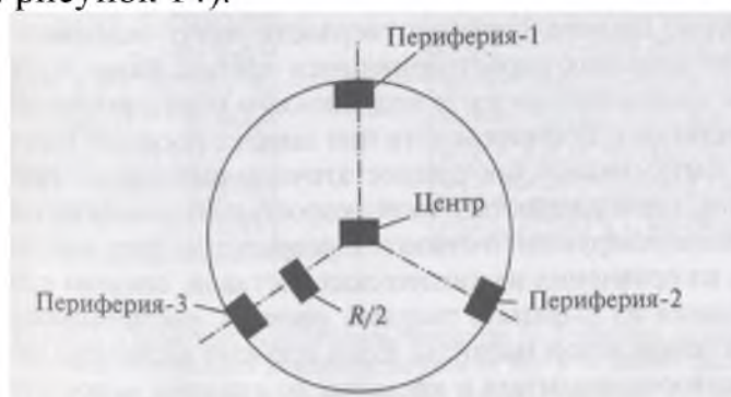
Рисунок 14 - Разметка разрезания образцов на темплете
