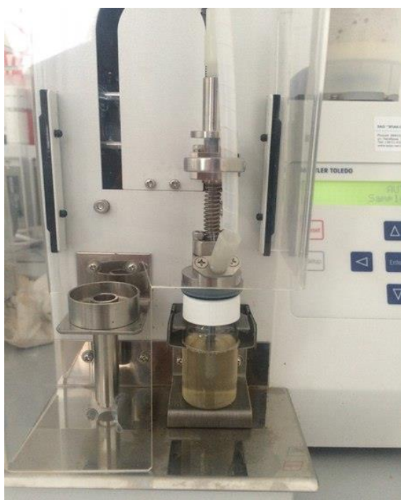
Рисунок 12 – Процесс нахождения плотности вещества
