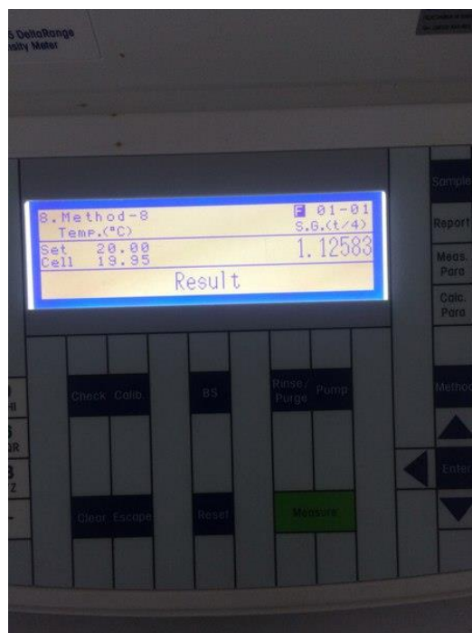
Рисунок 12 – Процесс нахождения плотности вещества
