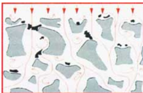
Рисунок 1.14 – Рентгеноскопический анализ показывает способность фильтра снизить турбулентность металла, втекающего в отливку
