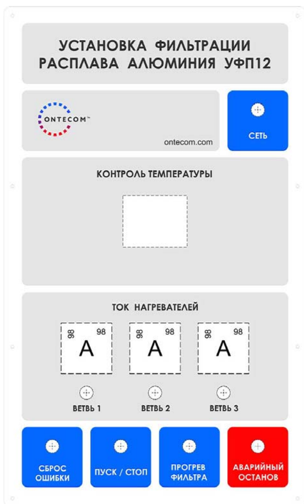
Рисунок 3.3 – Пульт управления фильтрующим боксом
