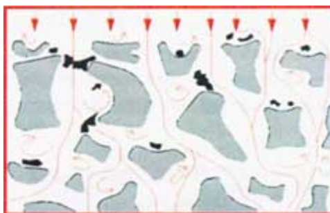
Рисунок 1.11 – Фильтрация внутри фильтра
