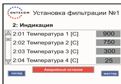
Рисунок 3.12 – Индикация «аварийный останов»
