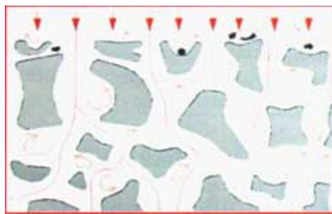
Рисунок 1.10 – Фильтрации скопившимися частицами
