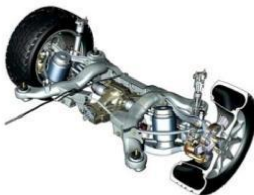
Рисунок 1.6 – Подвеска типа "Де Дион"
