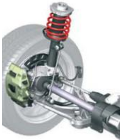
Рисунок 1.3 – Независимая подвеска типа МакФерсон
