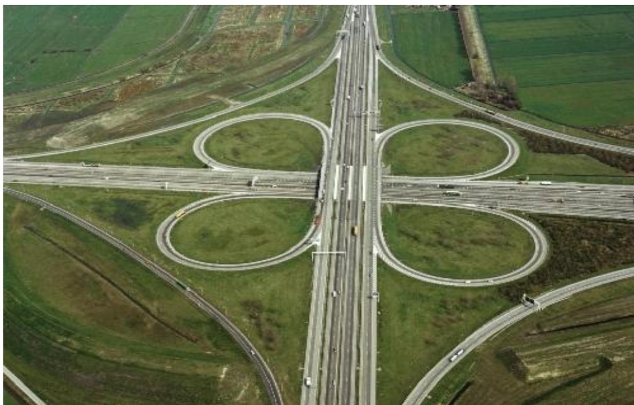
Рисунок 11 – Схема клеверообразной транспортная развязка
