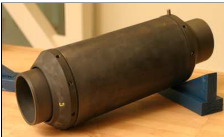
Рис. 3.6 Разбухающий заколонный пакер.
