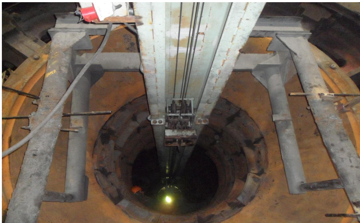
Рисунок 7 - Перифутеровщик завода НКМЗ
