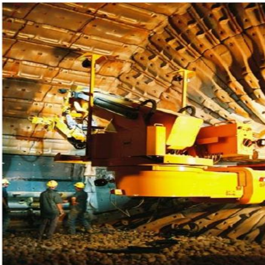
Рисунок 3 -Перефутеровка больших мельниц с помощью перефутеровщика
