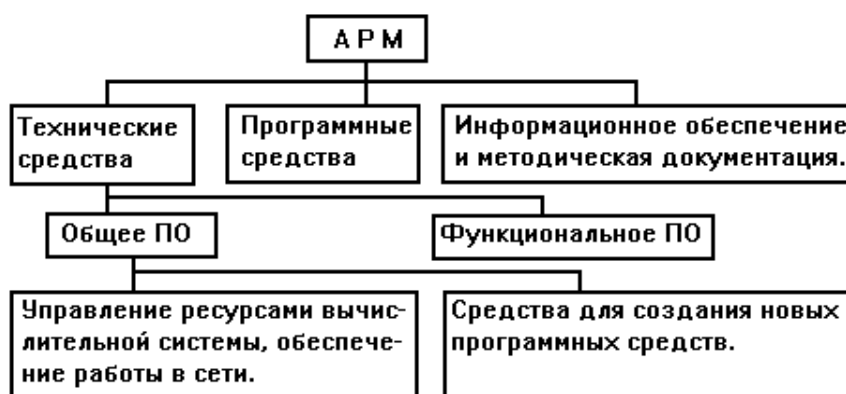
Рисунок 2 – Схема автоматизированного рабочего места
