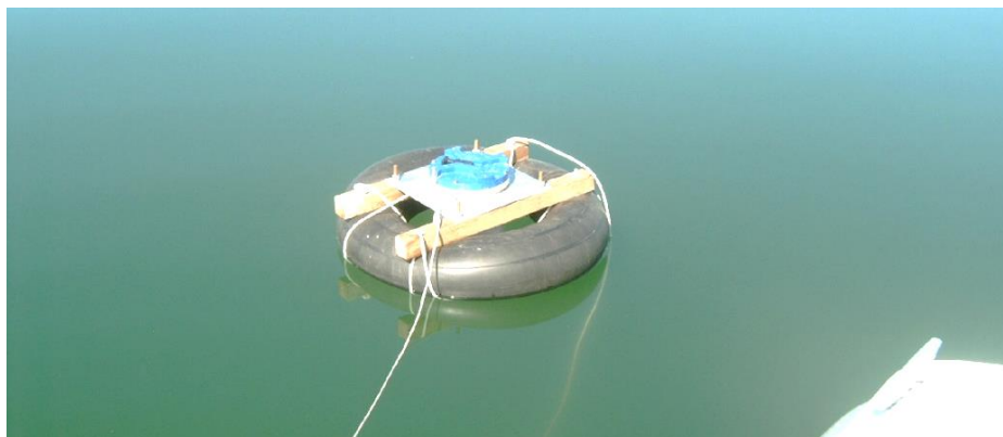
Рисунок 3 – Прибор ADCP на воде, озеро Шира
