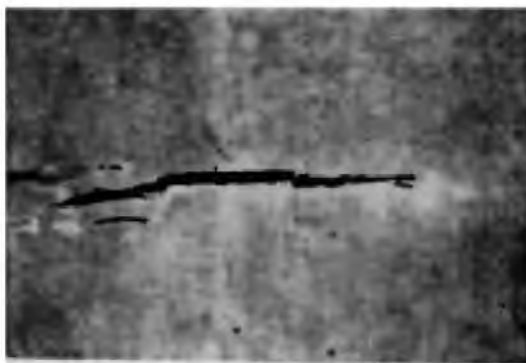
Рисунок 13 - Внутренняя трещина в поковке из сплава АК8
