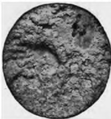
Рисунок 6 - Шлаковые включения в изломе разрывного образца штамповки из сплава АК6
