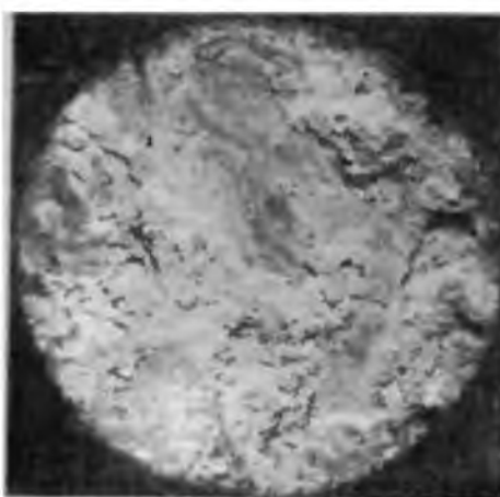
Рисунок 17 - Излом разрывного образца поковки сплава АМг6 с макронесплошностями темно-серого цвета с желтоватым оттенком
