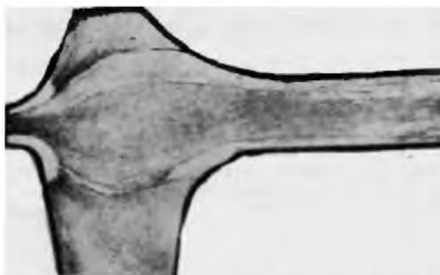
Рисунок 11 - Нарушение сплошности металла в зоне расположения прострела у штамповки из сплава АК6
