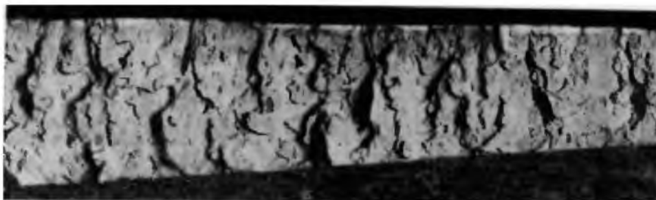
Рисунок 19 - Характерный вид излома поковок из алюминиевых сплавов с микронесплошностями серого цвета
