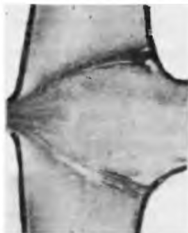
Рисунок 10 - Макроструктура штамповки из сплава Д16ч с прострелом
