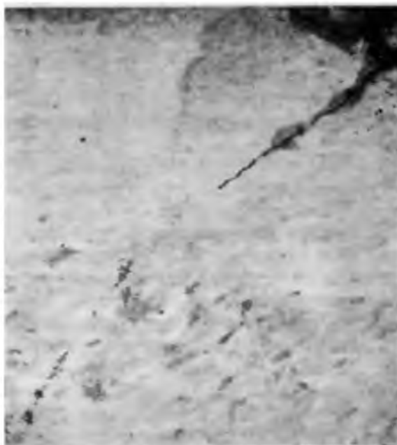
Рисунок 9 - Макроструктура поковки из сплава типа АК6 с поверхностной трещиной, образовавшейся по месту расположения неслитины в слитке
