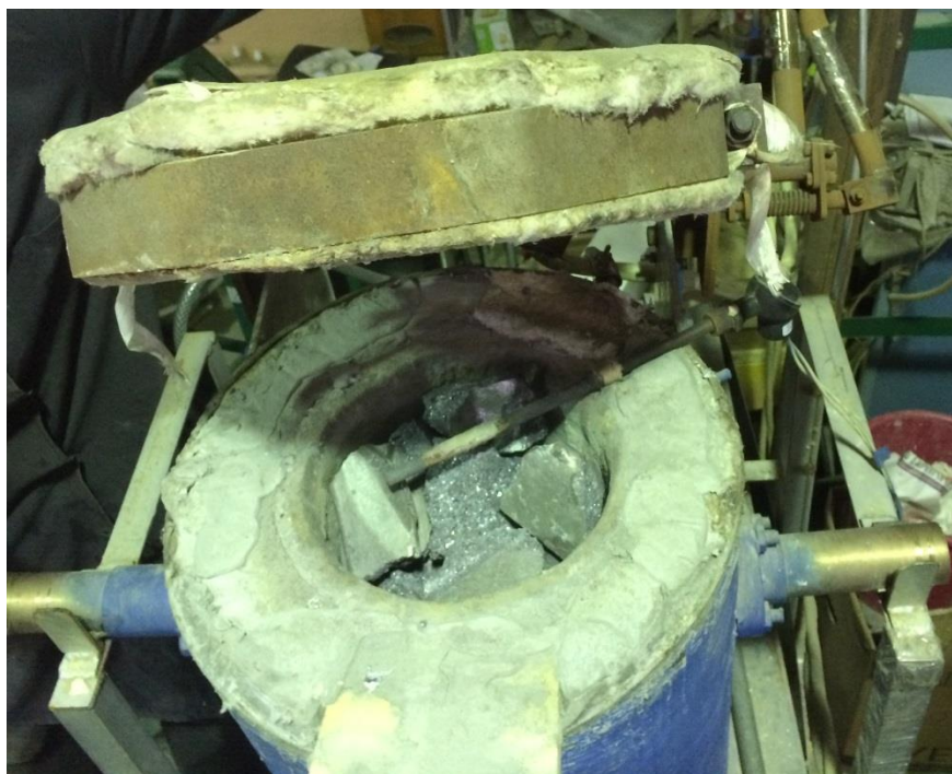
Рисунок 3.2 – Индукционная тигельная печь
