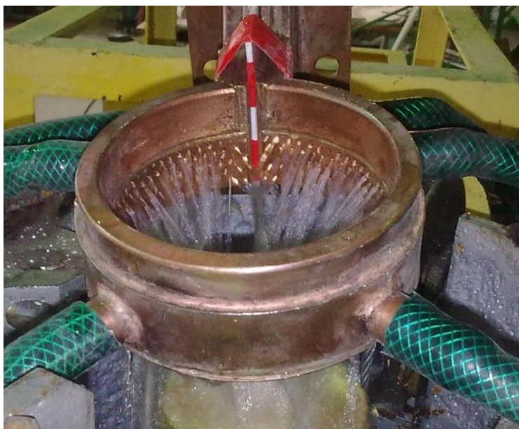
Рисунок 3.3 – Индуктор электромагнитного кристаллизатора
