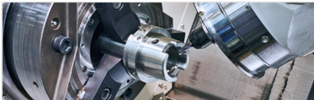
Рисунок 108 - Токарно-фрезерная обработка
