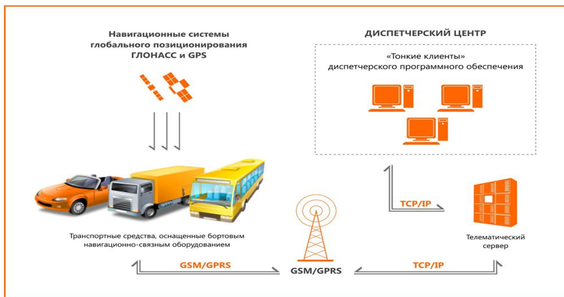
Рисунок 3 – Схема работы спутникового мониторинга транспорта
