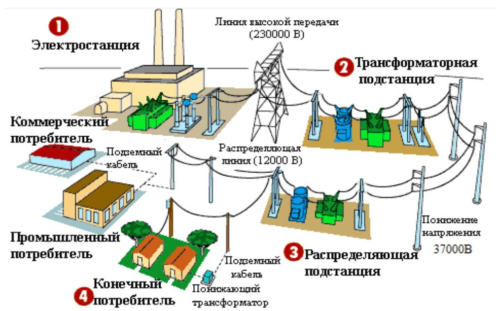
Рисунок 1.20 – Условная схема высоковольтной линии передачи [26]
