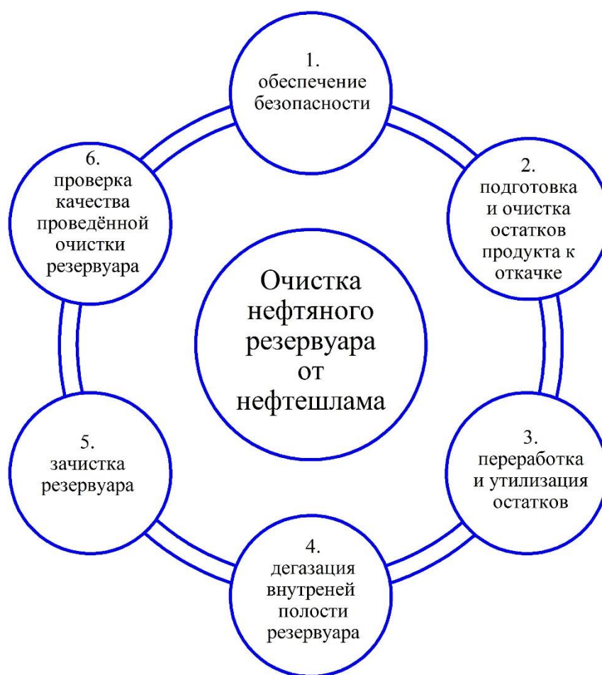
Рисунок 3.1.1 – Общая схема процесса очистки
