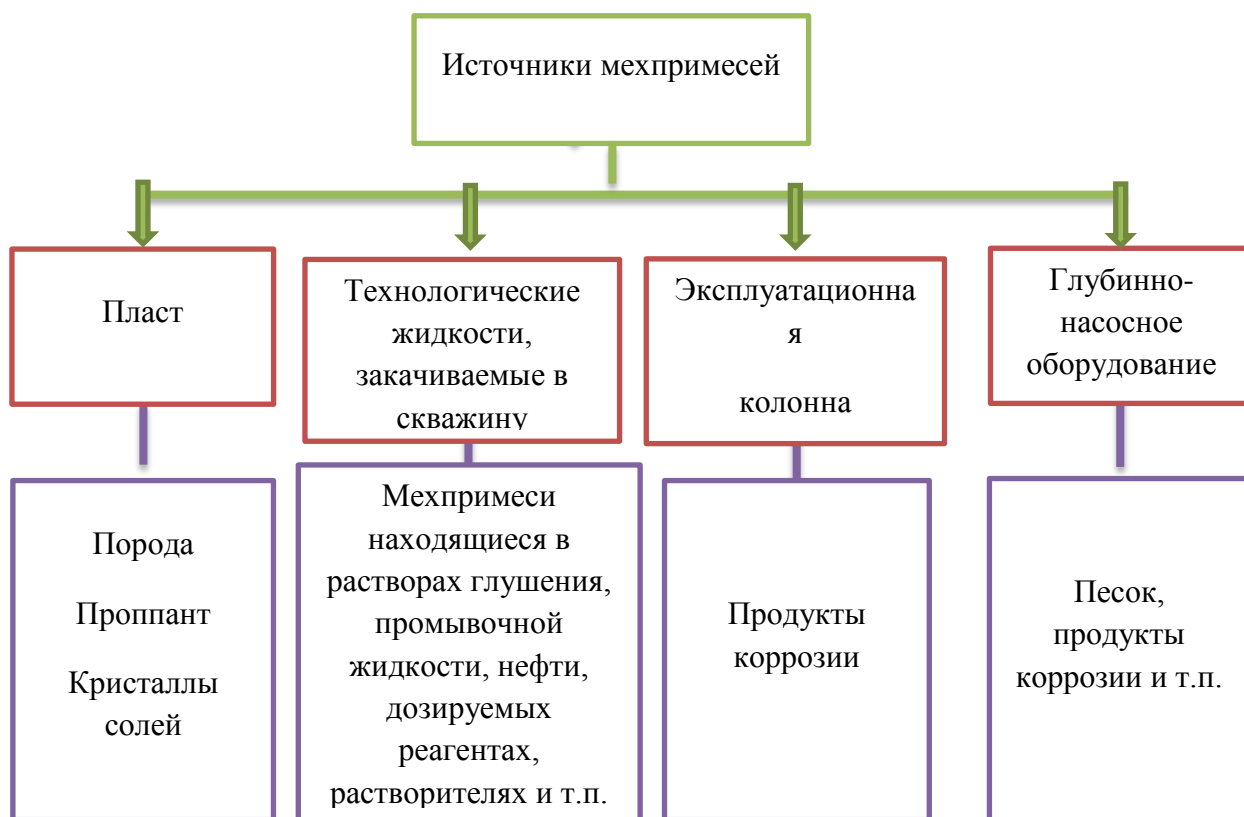
Рисунок 1.1.1 — Источники механических примесей
