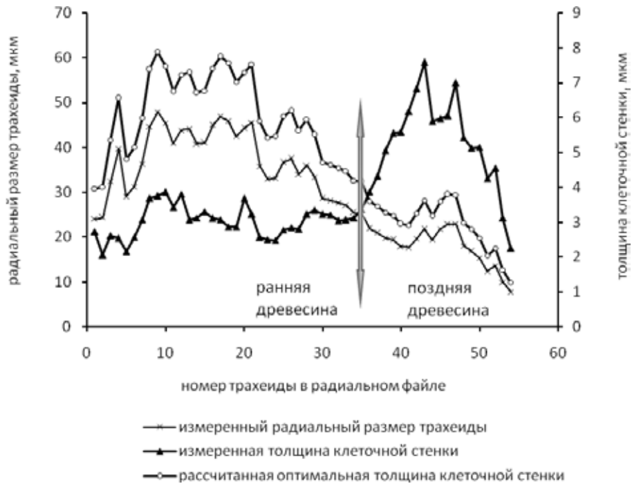
Рис. 4. Изменчивость измеренных ТКС, РРТ (среднее для трех радиальных рядов) и рассчитанного по уравнению оптимального значения толщины клеточной стенки h вдоль радиуса кольца
