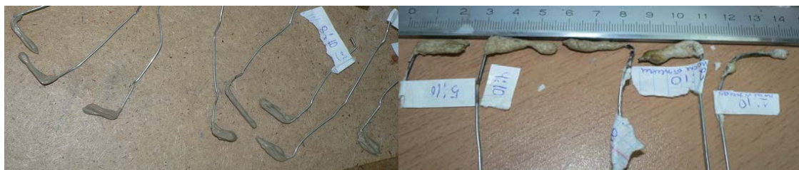
Рис.1 Образцы для определения объёмного расширения до и после отжига
