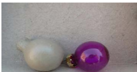
Рис.2 Шарики до и после футерования
