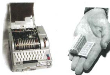
Рис. 2 – Шифрмашинa M-125 «Фиалка» и кодовая книга советского разведчика
