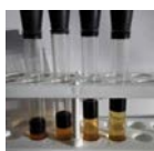
Фото1. Отделение воды от нефти при помощи средства Vinet.
