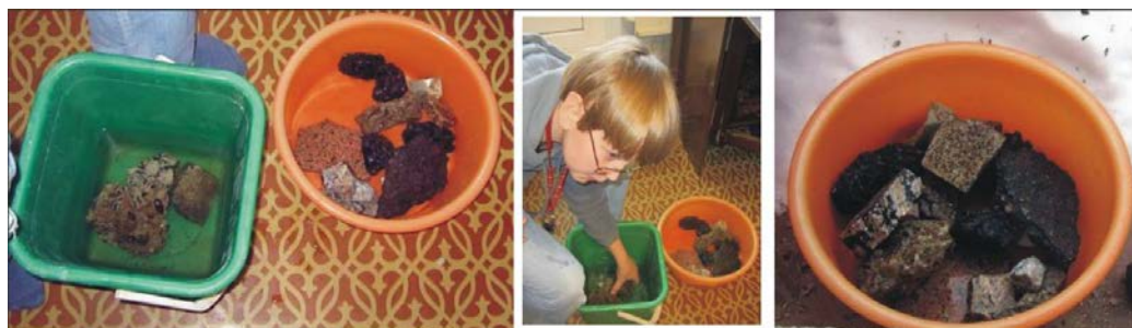
Рис. Этапы эксперимента по определению морозостойчивости образцов: предварительное замачивание и оттаивание (слева), перекладывание образцов в тазик (в центре), замораживание увлажненных образцов на балконе (справа).
