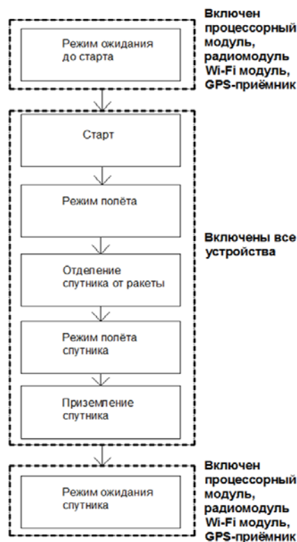
Рис.4 Блок-схема работы пикоспутника
