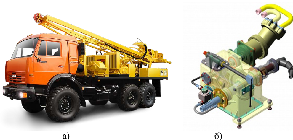
Рис.1 – Система верхнего привода буровой установки УРБ-2А-2: а – общий вид; б – вращатель
