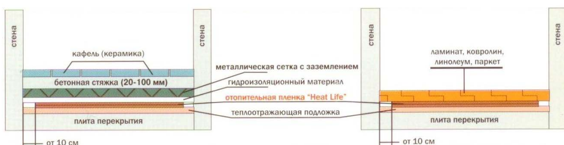
Рис.2 – Укладка инфракрасной пленки
