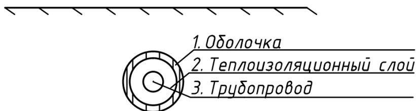
Рис.1 – Тепловая изоляция трубопроводов
