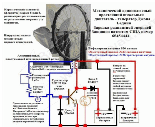
Рис.3. Мотор Бедини и принципиальная схема заряда.
