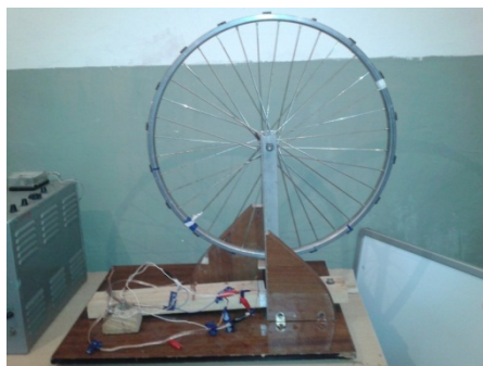
Рис 4. Экспериментальная установка с колесом и магнитами.
