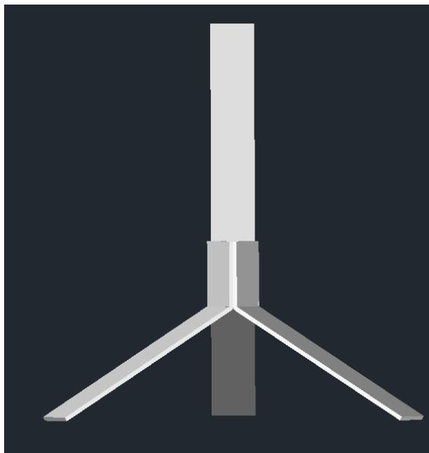
*Рис. Объемно-распорная конструкция элемента фибры*
