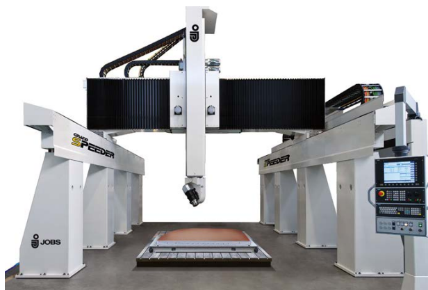
Рис.4. Высокоскоростной фрезерный станок для применения в аэрокосмической промышленности семейства «Speeder» компании «Jobs».
