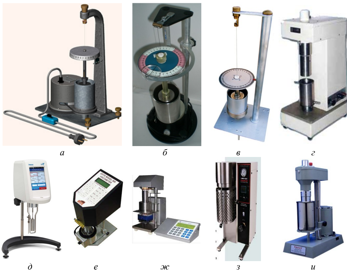
Рисунок 1. Приборы контроля статического напряжения сдвига, предельного напряжения сдвига и пластической вязкости бурового раствора: а – СНС-2; б – СНС-2М; в – СНС-3; г - ВСН-3; д – ротационный вискозиметр Брукфильда серии DV2T; е – ротационный вискозиметр серии OFITE; ж – ротационный вискозиметр серии ZIM; з – ротационный вискозиметр серии CHANDLER; и – ротационный вискозиметр серии FANN.
