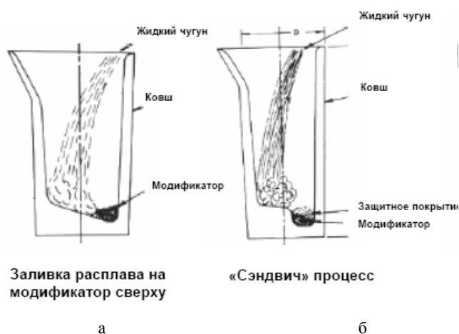
Рис. 5. Примеры ковшей для модифицирования методами а – заливки расплава на модификатор; б – «сэндвич»-процесса
