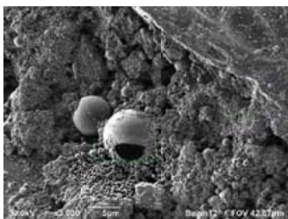
Рис. 8. Исходный шлам с микросферами (на переднем плане видна микросфера, разрезанная ионным пучком)
