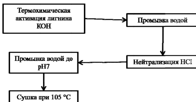
Рис. 1. Схема процесса термохимической активации лигнина древесины березы гидроксидом калия
