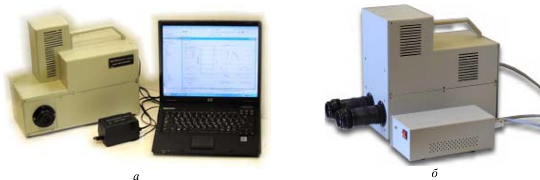
Рис. 1. Внешний вид широкодиапазонных спектрорадиометров: а – полевой спектрорадиометр ПСР-02; б – переносной высокоточный спектрометр ПВС-02
