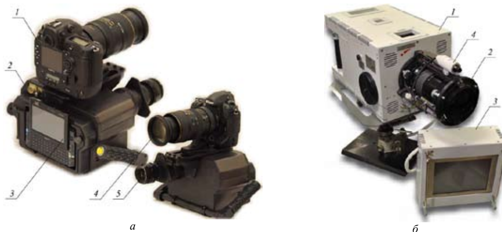
Рис. 5. Внешний вид космических видеоспектральных систем: а – ФСС (1 – модуль регистрации изображений (МРИ); 2 – модуль спектрометрический (МС); 3 – планшетный компьютер модуля электроники; 4 – объектив МРИ; 5 – объектив МС); б – ВСС (1 – базовый блок; 2 – блок объектива; 3 – блок монитора; 4 – камера видеосопровождения)
