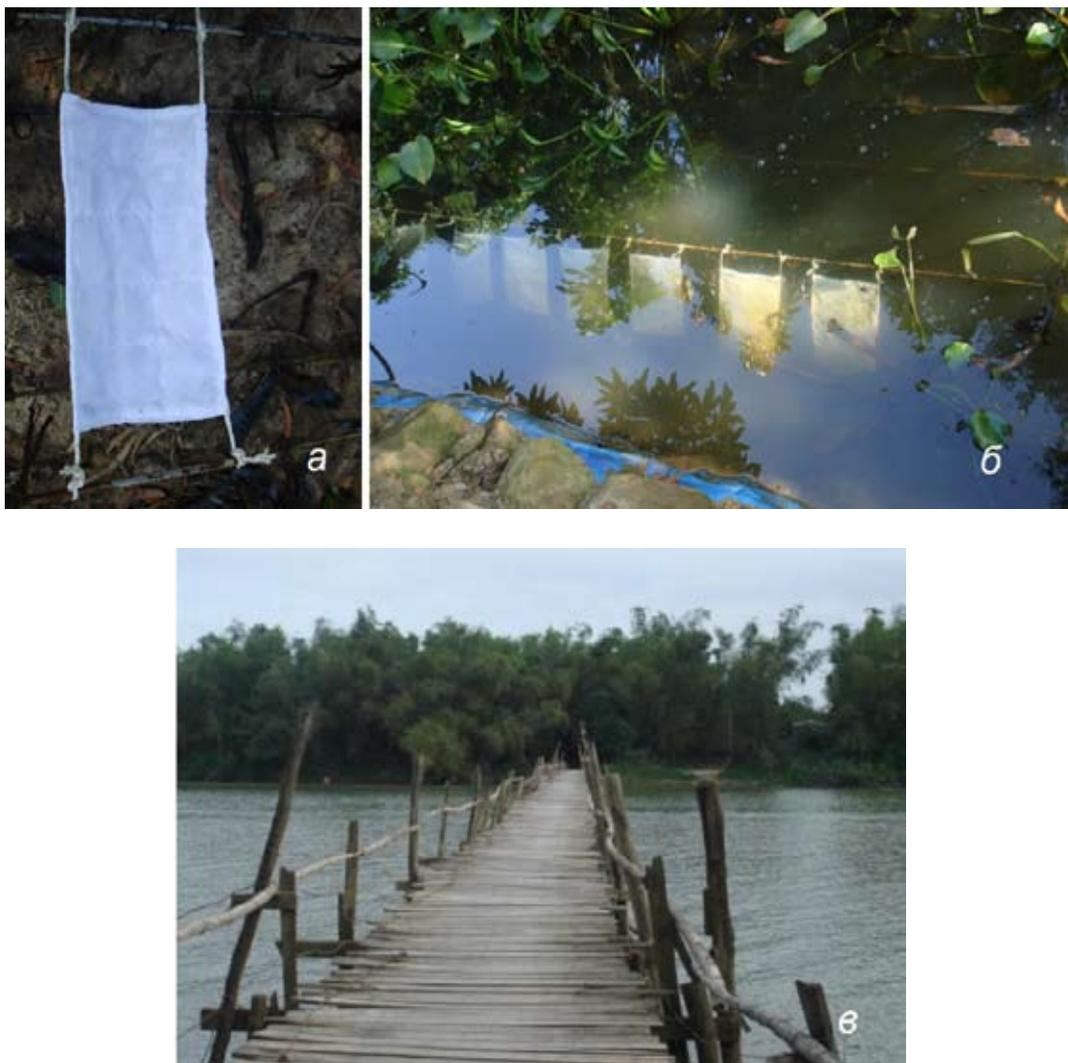
Рис. 1. Установка образцов на экспозицию: а – внешний вид чехла с образцами; б – размещение чехлов в искусственном водоеме; в – место размещения образцов в реке Кай
