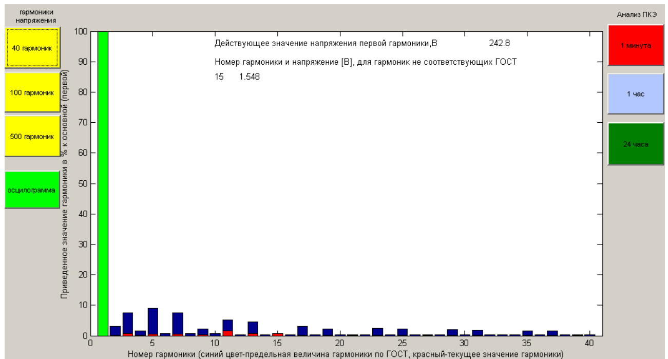
Рисунок 3 – Интерфейс модуля расчета высших гармонических
