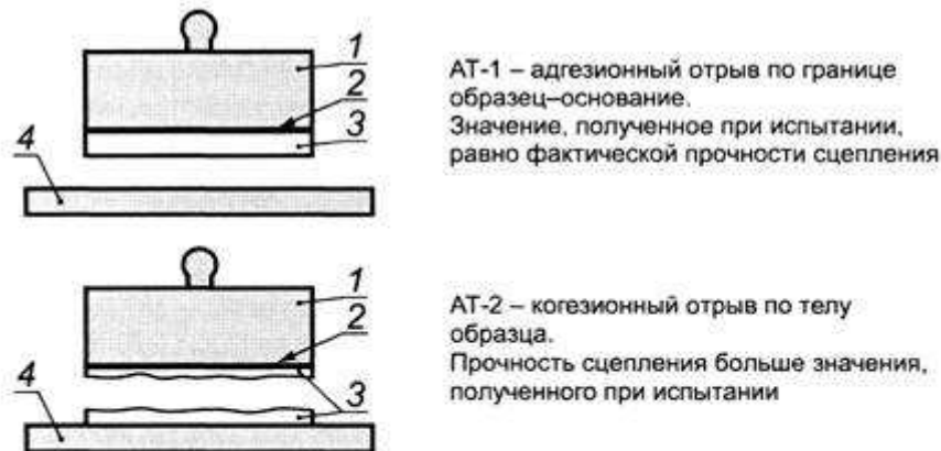
Рисунок 4 - Варианты отрыва образца от основания: 1 - металлический штамп; 2 - клей; 3 - образец; 4 - бетонная плита (основание)
