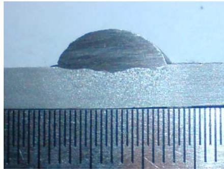
Рисунок 5 - Поперечное сечение валика, выполненного пучком из трех электродов.
